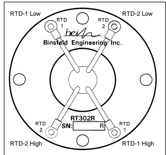
Rotor-RTD Wiring Diagram
