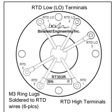
Rotor-RTD Wiring Diagram
