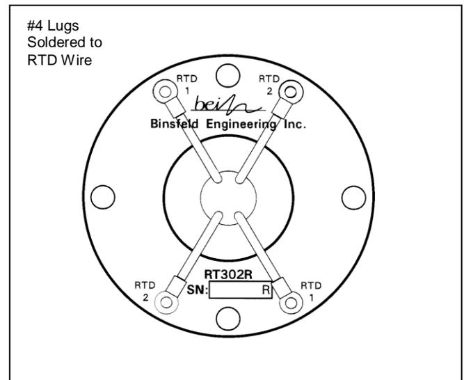
Rotor-RTD Wiring Diagram
