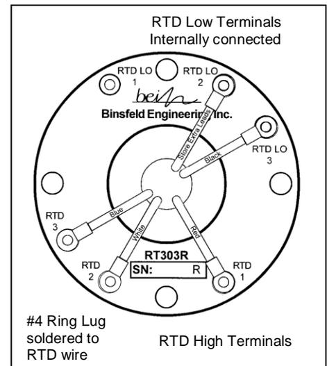
Rotor-RTD Wiring Diagram
